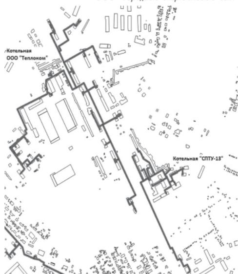
Рисунок 13 Схема теплоснабжения объектов от котельной "ООО 'Теплоком'", котельной "СПТУ-13" ООО "Городские энергетические сети"
