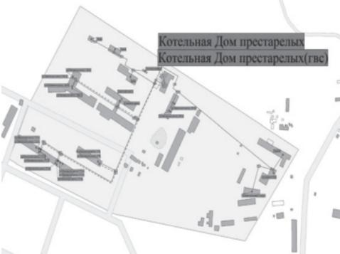
Рисунок 17 Схема теплоснабжения объектов от котельной "Дом Престарелых" ООО "Городские энергетические сети"
