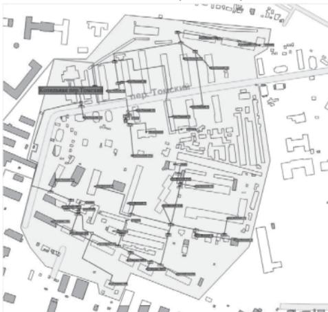
Рисунок 10 Схема теплоснабжения объектов от котельной "Томская" ООО "Городские энергетические сети"
