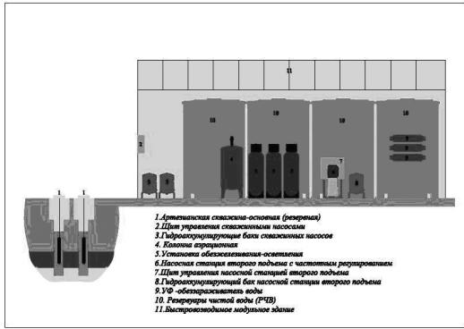
Рисунок 4.11. Состав блочно-модульных систем водоподготовки
