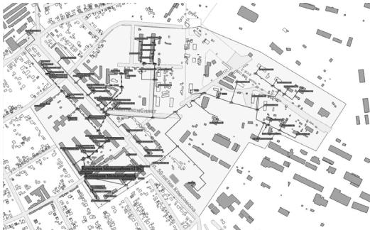
**Рисунок 10 Схема теплоснабжения объектов от котельной "Мелькомбинат" ООО "Городские энергетические сети"**
