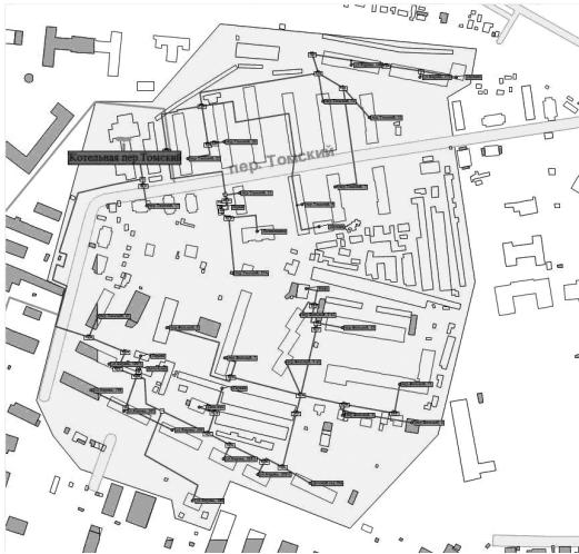
**Рисунок 11 Схема теплоснабжения объектов от котельной "Томская" ООО "Городские энергетические сети"**
