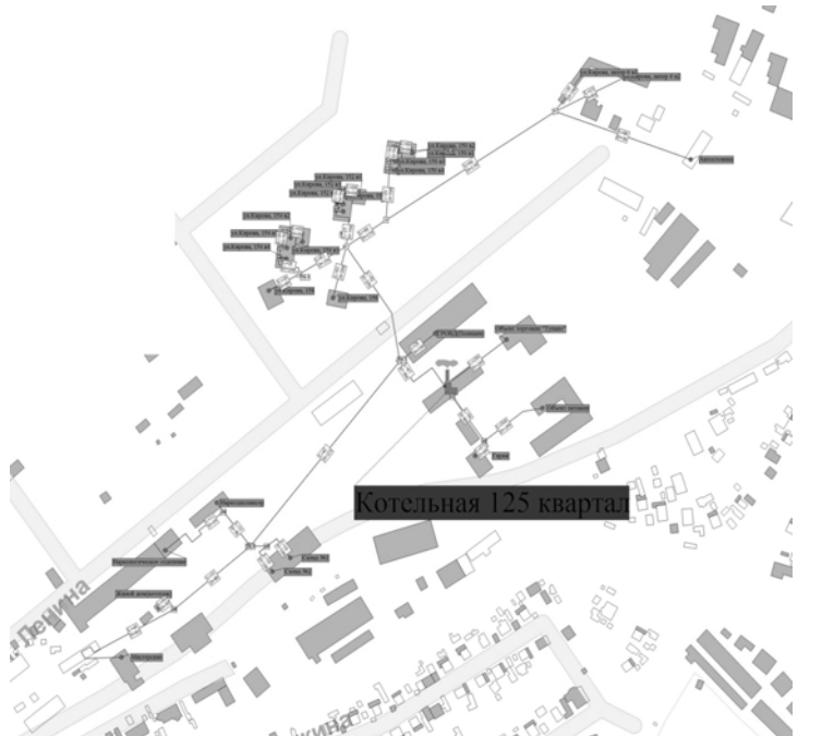
Рисунок 21. Тепловые сети от котельной "125 квартал"
