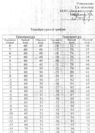
Рисунок 20. Температурный график сетевой воды, отпускаемой котельной ООО "Дальжилстрой"
